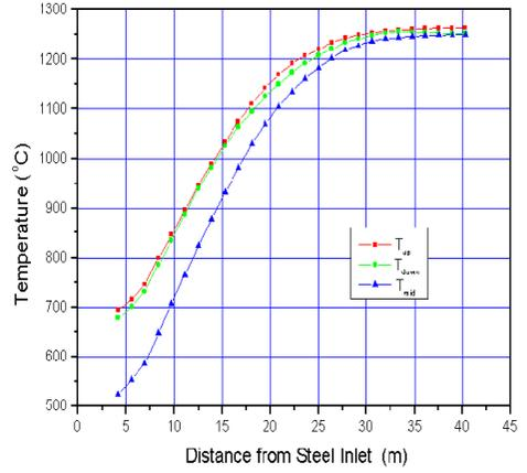
图 11 钢坯上下表面及中心温度分布线图
