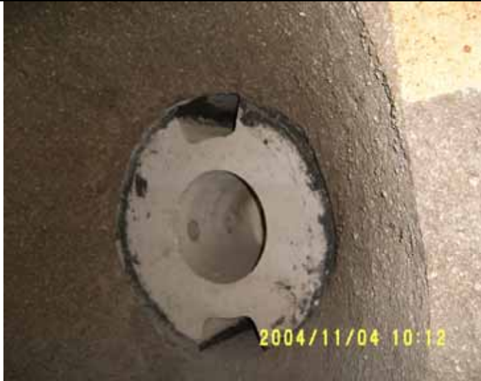
图 1：蓄热式烧嘴有角度的喇叭状喷口
