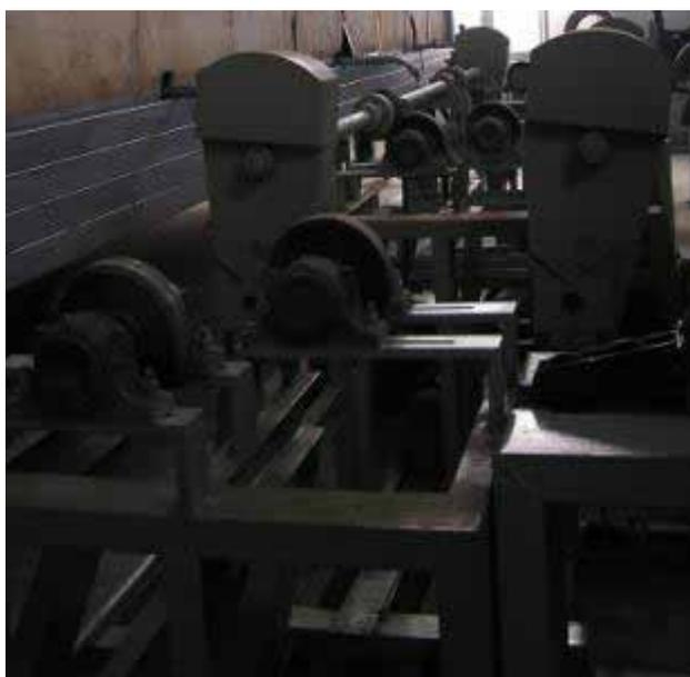
图 6 涂塑工位摩擦轮
