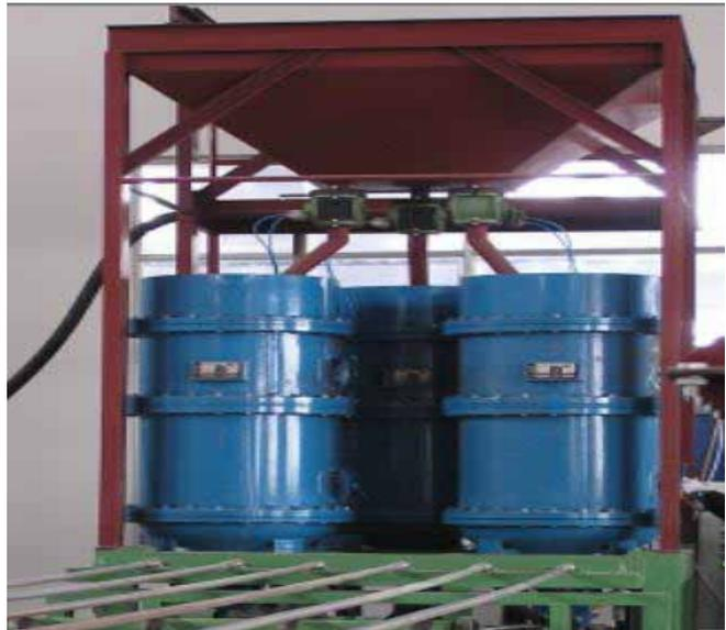
图 4 钢管内壁喷砂设备
